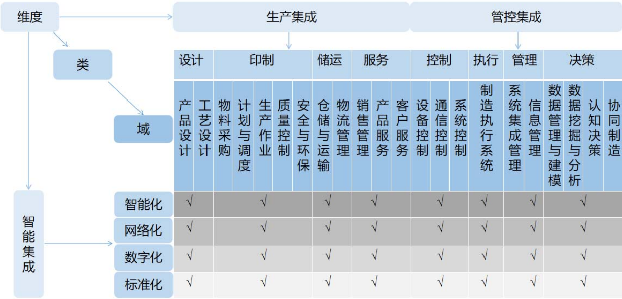
图 2 印刷智能工厂模型架构
